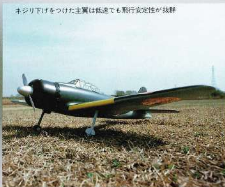
ネジリ下げをつけた主翼は低速でも飛行安定性が抜群
