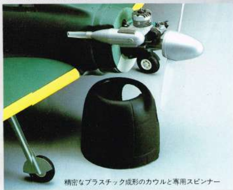
精密なプラスチック成形のカウルと専用スピナー
